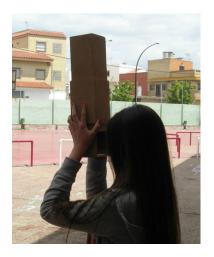
El periscopio que hemos construido nos permite girar el espejo superior en ángulos de 90º alrededor de la vertical. Al girar el espejo superior en torno a la vertical los objetos del horizonte tendrán igualmente la misma rotación.
